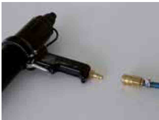
Druckluft anschließen oder Handpresspistole vorbereiten
